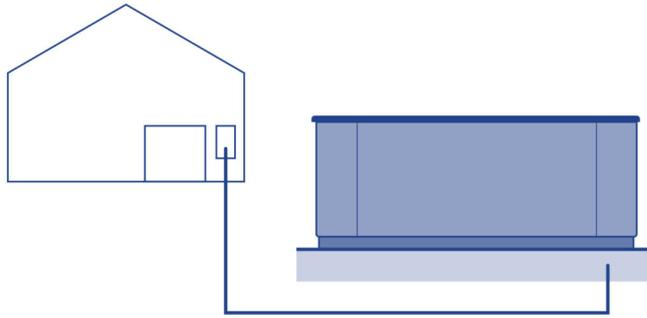
Prüfen Sie, ob der Differenzialschalter auf Position OFF (Geschlossen) steht. Schalten Sie den Differenzialschalter erst dann auf Position ON (Geöffnet), wenn der Whirlpool mit Wasser gefüllt ist.
