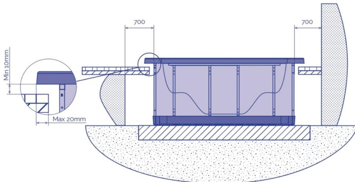
Sobald Spa richtig installiert , beenden Sie die Arbeit mit Fliesen o.ä. unter Berücksichtigung, dass die Kontur des Gehäuses des Spa sollte nie in direkten Kontakt mit dem Mauerwerk sein ( Sie müssen mindestens 2 cm lassen um die Kontur ).
