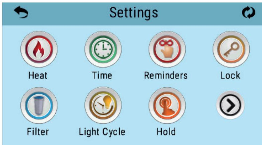
Das Symbol "Heizung"
