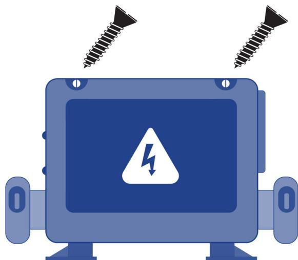
Schließen Sie die Schalttafel des Spa mit dem Differential.
