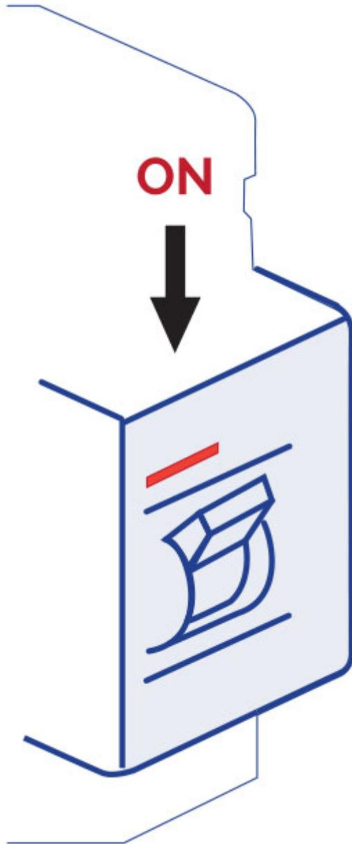
Die elektrische Installation muss einen hochsensiblen Differentialschalter mit zwei Polen am Eingang des allgemeinen Stromnetzes besitzen (dieser Differentialschalter wird nicht mit dem Whirlpool geliefert).
