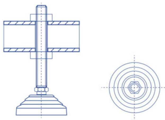
Das Spa muss vollkommen von der Trägerstruktur abgestützt werden, es darf niemals über das obere Profil gestützt werden, da durch die eventuelle Verbiegung des Körpers (Becken) das Spas brechen könnte.
