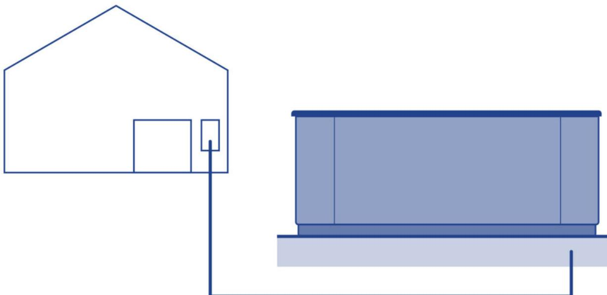
Comprobar que el diferencial esté en posición OFF (Cerrado). No sitúe el diferencial en la posición ON (abierto) hasta que el Spa esté lleno de agua.
