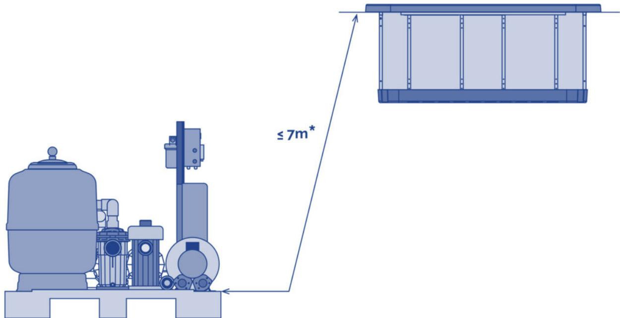
\* Atención dichas distancias máximas son las del recorrido de la tubería de conexión entre el equipo y el Spa.
