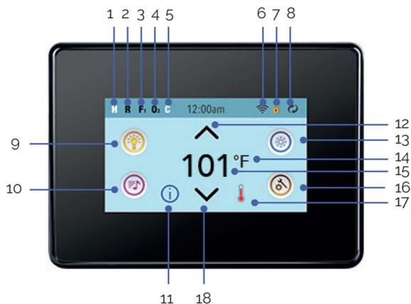
1. H = Rango de temperatura alta. L = Rango temperatura baja
