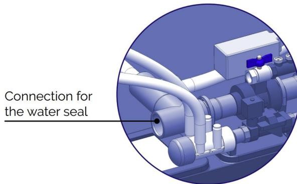
El cierre hidráulico debe conectarse a través de una tubería de PVC de extremo liso de 50 mm de diámetro.
