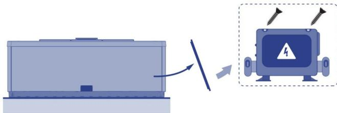
2. Abra el mueble de control y conecte el panel eléctrico del spa al diferencial.
