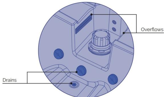
Cuando se sigue un proceso continuo de llenado de agua, el spa tiene un circuito de desbordamiento compuesto por dos desbordes ubicados por encima de la altura del filtro telescopico. Estos descargan el exceso de agua al sistema de desagüe del edificio después de pasar por el cierre hidráulico (no suministrado con el spa), independientemente de si la SV está abierta.
