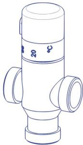
Si la temperatura de entrada de agua fría no es la misma, o si desea una temperatura en la bañera de hidromasaje diferente a las indicadas en la tabla, puede que sea necesario ajustar ligeramente la posición, según corresponda.
