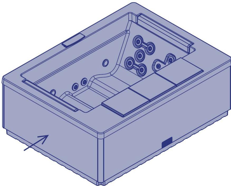
2. Conecte los dos tubos de suministro de agua con una rosca macho G 3/8" (véase la imagen a continuación). Conecte la salida de agua caliente con la válvula de bola a la válvula roja, y la salida de agua fría a la válvula azul.
