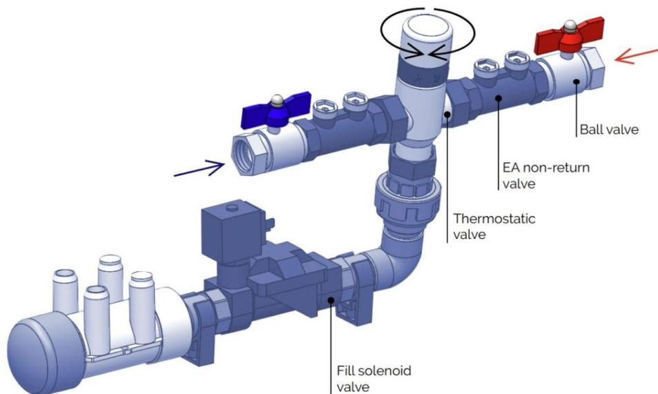
Una vez hecho esto, la válvula termostática recibe agua fría de la red de suministro de agua y agua caliente del sistema de Agua Caliente Sanitaria (ACS) donde se encuentra el spa. Esto permite ajustar la temperatura deseada a la que se llena el spa a través de la cascada.
