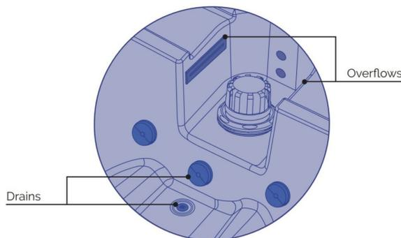
Cuando se sigue un proceso continuo de llenado de agua, el spa tiene un circuito de desbordamiento compuesto por dos desbordes ubicados por encima de la altura del filtro telescópico. Estos descargan el exceso de agua al sistema de desagüe del edificio después de pasar por el cierre hidráulico (no suministrado con el spa), independientemente de si la SV está abierta.
