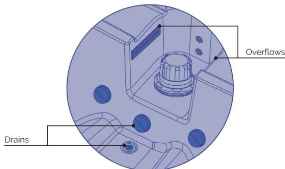
Cuando se sigue un proceso continuo de llenado de agua, el spa tiene un circuito de desbordamiento compuesto por dos desbordes ubicados por encima de la altura del filtro telescopico. Estos descargan el exceso de agua al sistema de desagüe del edificio después de pasar por el cierre hidráulico (no suministrado con el spa), independientemente de si la SV está abierta.
