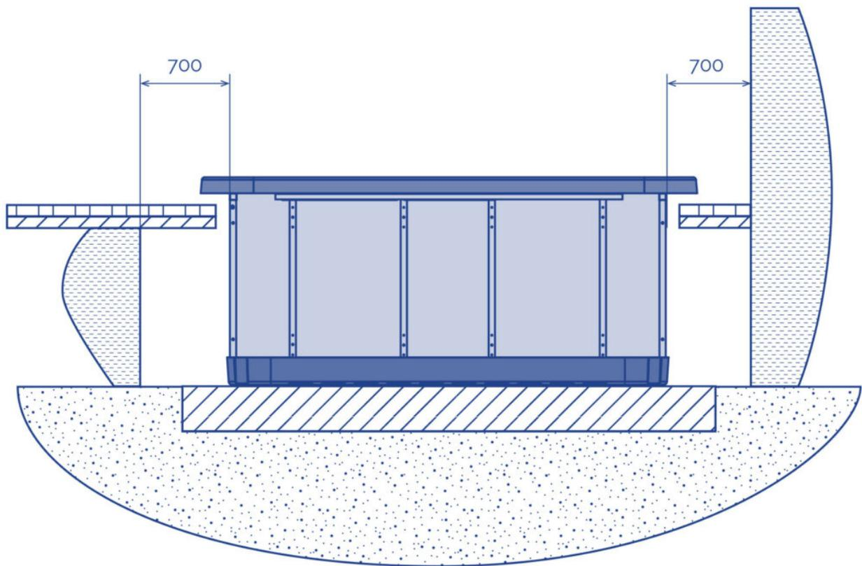
No rellenar nunca el perfil superior del Spa con Cemento u otro material que pudiera tener una dilatación / contracción distinta a la del casco. El Spa acabaría agrietándose.
