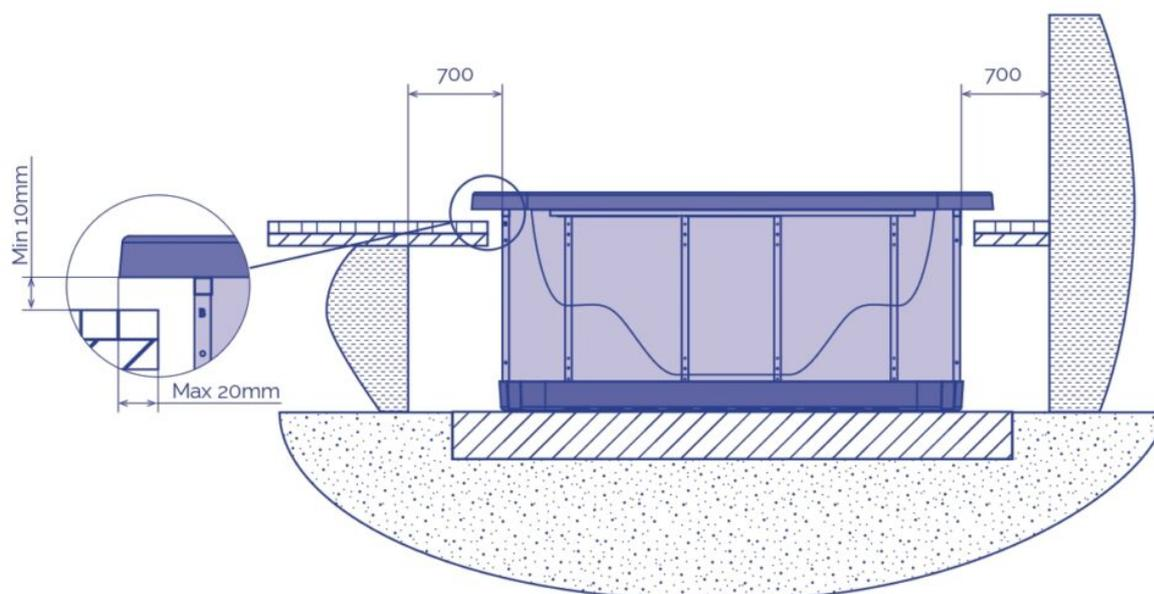
Une fois le spa posé correctement, terminez la maçonnerie en posant du carrelage ou similaire et en veillant à ce que le contour de la coque du spa ne soit jamais en contact direct avec la maçonnerie (il faut laisser une marge d'au moins 1 centimètres sut tout le pourtour).
