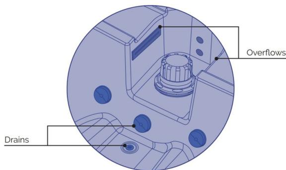
Lors du processus de remplissage continu de l'eau, le spa dispose d'une boucle de trop-plein composée de deux trop-pleins situés au-dessus de la hauteur du filtre télescopique. Ils déchargent l'excédent d'eau dans le système de drainage du bâtiment après être passés par le joint d'eau (non fourni avec le spa), que la SV soit ouverte ou non.
