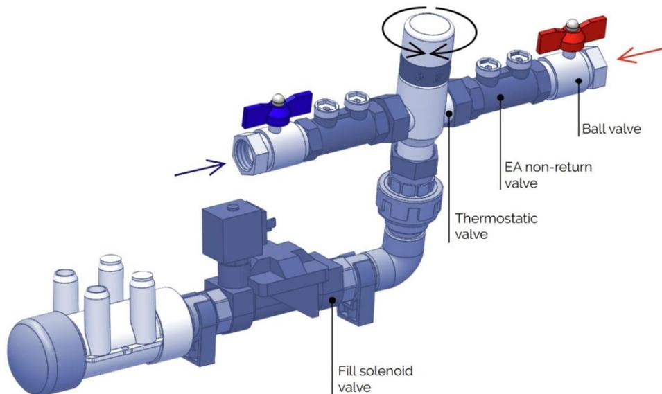
Lorsque cela est fait, la vanne thermostatique reçoit l'eau froide du réseau d'approvisionnement en eau et l'eau chaude du système d'Eau Chaude Sanitaire (ECS) dans lequel le spa est installé. Cela permet de régler la température souhaitée à laquelle le spa est rempli tout au long de la cascade.
