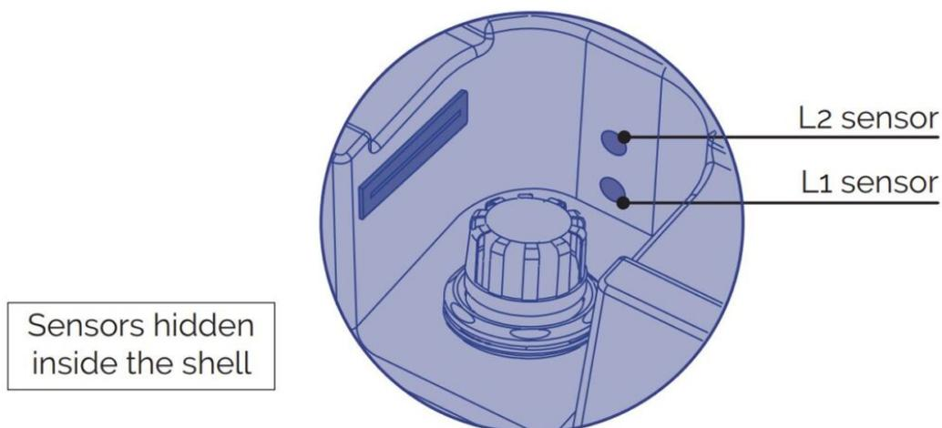
Le niveau L1 est considéré comme sûr à condition que le capteur détecte de l'eau pendant au moins 3 secondes consécutives. Si l'eau n'est pas détectée pendant ce laps de temps, le système reste éteint, ce qui active automatiquement la procédure de remplissage.
