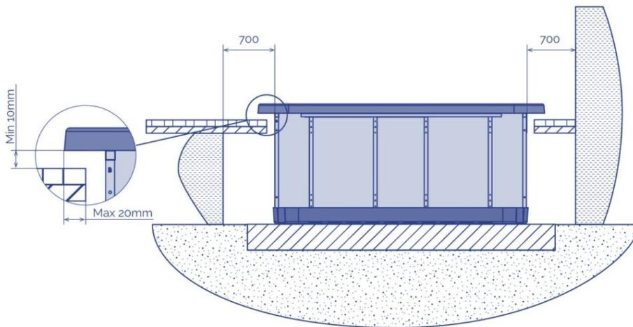
Une fois le Spa installé, terminez les travaux en tenant compte du fait que le bord de la surface ne doit pas être en contact direct avec l'ouvrage (un minimum de 1 cm doit être laissé autour du bord).
