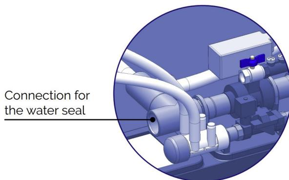
Le joint d'eau doit être connecté via un tuyau en PVC à extrémité lisse d'un diamètre de 50mm.
