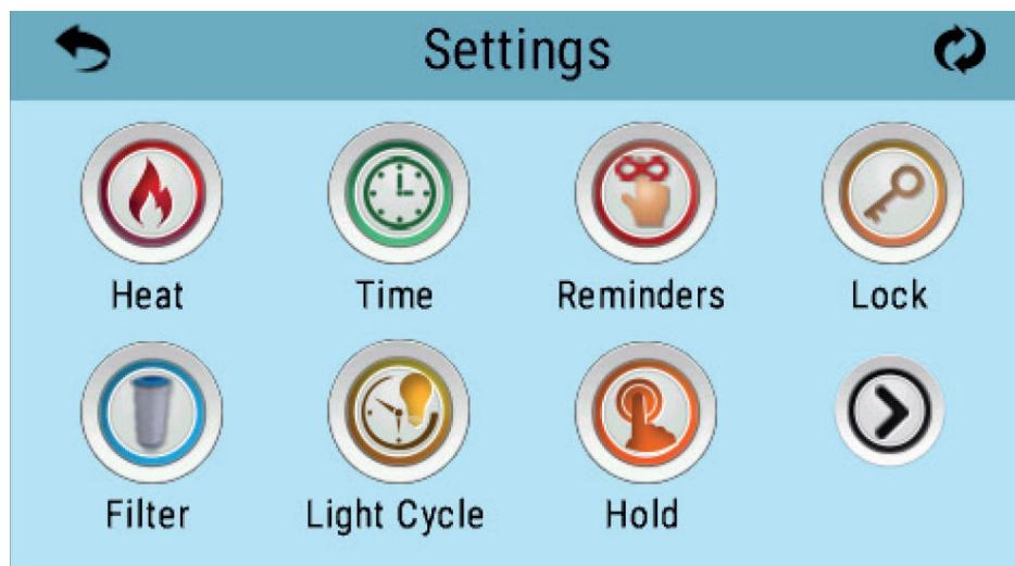
Selezionando l'icona Riscaldamento (Heat) si accede alla schermata di controllo di tale modalità e del relativo intervallo di temperatura.
