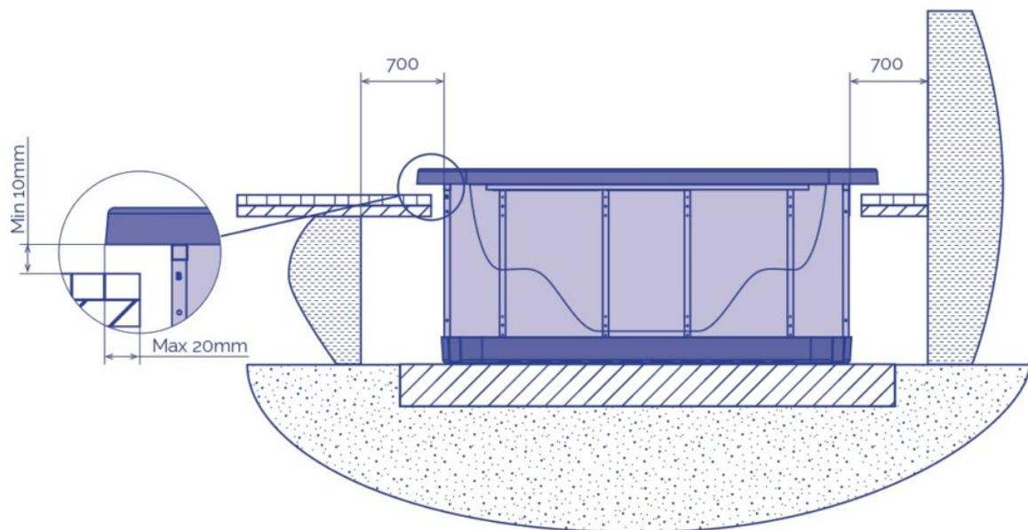
Una volta insediato lo spa in maniera corretta, terminare l'opera con piastrelle o simili tenendo in conto che il contorno dell'involucro dello spa non deve mai stare a contatto diretto con l'opera in muratura (si deve lasciare un minimo di 2 centimetri in tutto il contorno).
