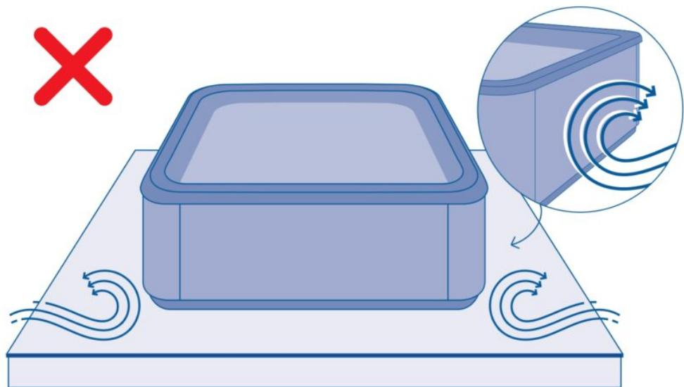
Assicurarsi di fornire una ventilazione adeguata ai mobili per evitare possibili deformazioni.
