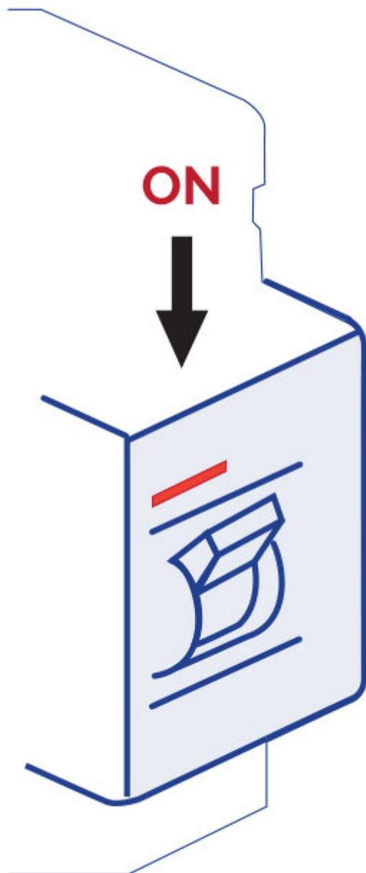
L'installazione elettrica deve comprendere un differenziale ad elevata sensibilità a 2 poli nel quadro generale di entrata della corrente (il differenziale non viene fornito con la SPA).
