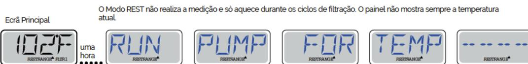
O Ecrã Principal vai mostrar RUN PUMP FOR TEMP se a bomba de filtração tiver estado sem funcionar durante mais de 1 hora
