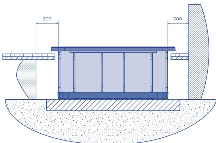
Não encher jamais o perfil superior do Spa com cimento ou outro material que possa ter uma dilatação/ contracção distinta à do casco. O Spa acabaria por gretar.
